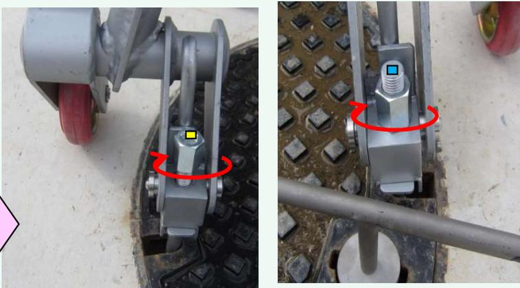
④ナットを締め付けフックを固定
